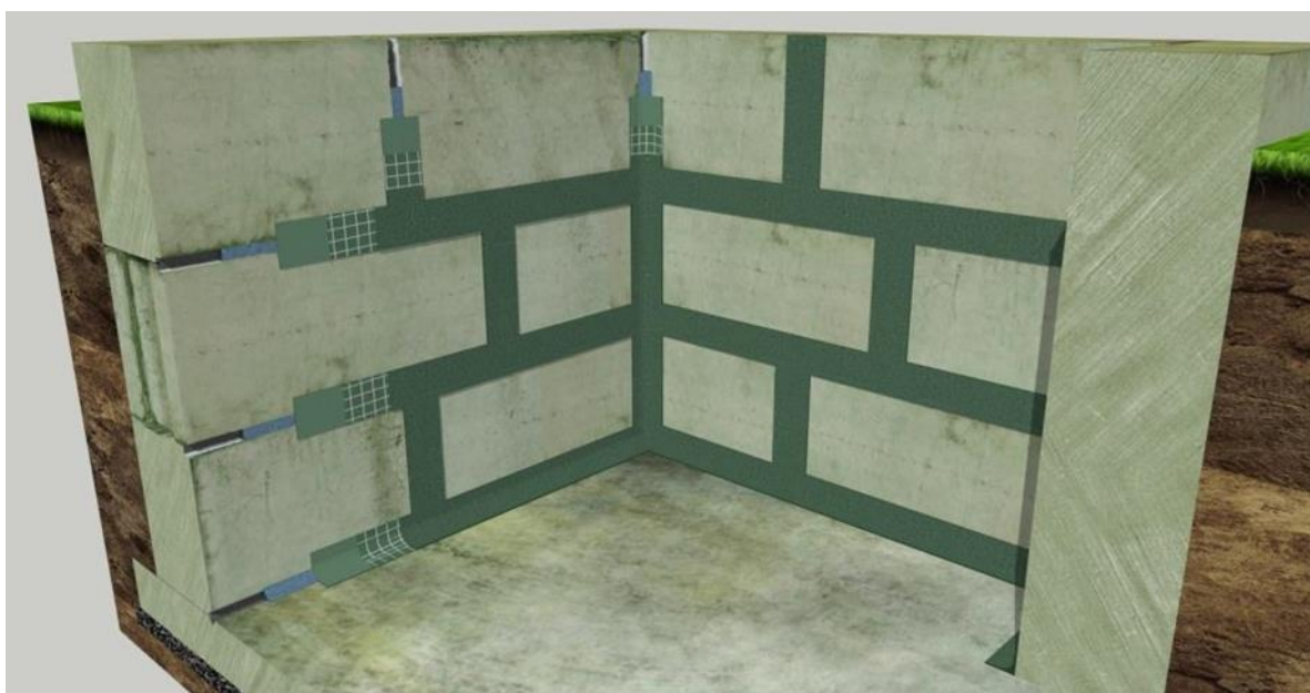
Рисунок 4 – После обработки швов (см. рисунок 2) нанести обмазочную гидроизоляцию «КТтрон-10 2К» (Эластичную) с армированием стеклосеткой мелкоячеистой (5х5 мм). Прилегающие к швам поверхности захватить на 100 мм в каждую сторону
