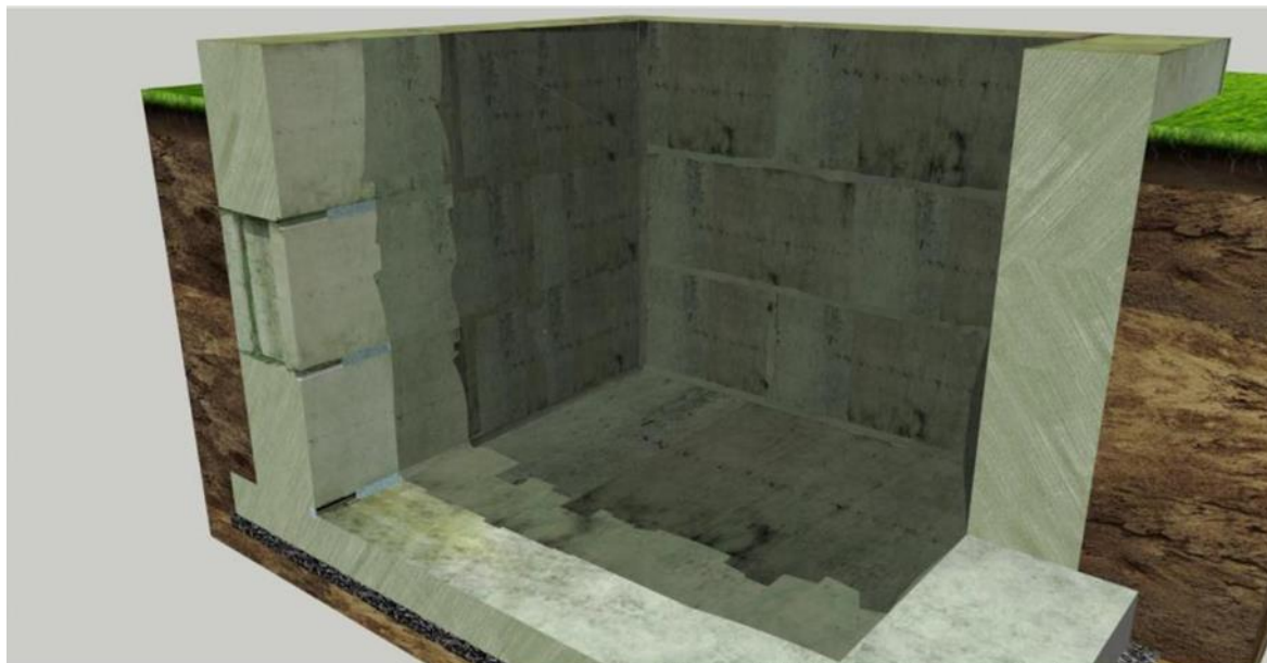
Рисунок 3 – Обработать все поверхности гидроизоляцией «КТтрон-1» (Проникающая) на 2 раза
