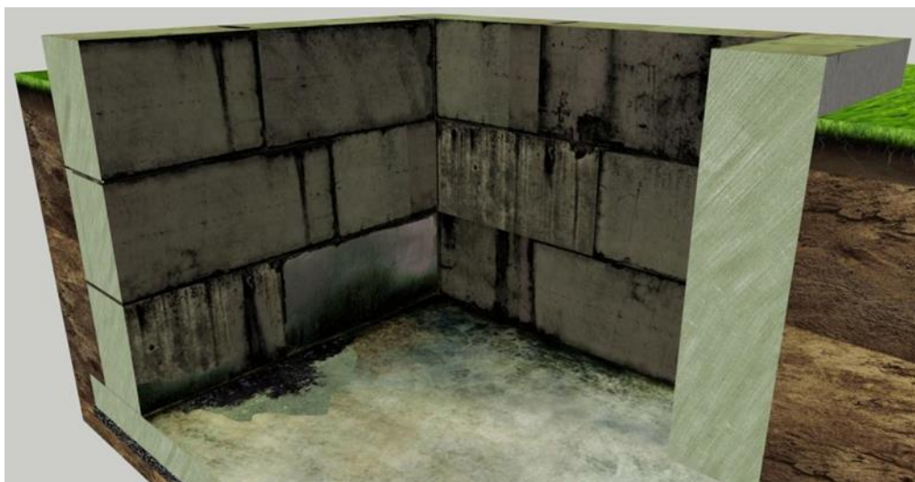
Рисунок 1 – Стена из блоков. Блоки намокли, швы текут
